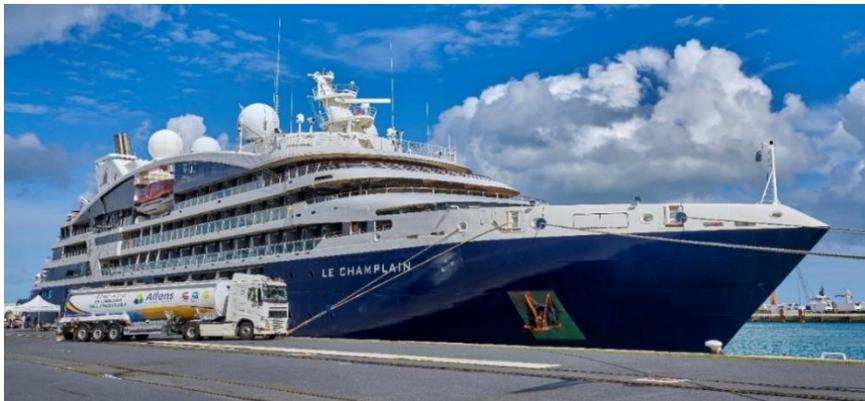
*Im Herbst 2023 testete die Le Champlain den Biokraftstoff B100, der aus in Frankreich recyceltem Altspeiseöl gewonnen wird. Der von ALTENS durchgeführte Test war der erste in Frankreich.*
