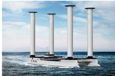
Vue ¾ avant du navire-énergie FARWIND avec voiles-rotor ©Cabinet Mauric
