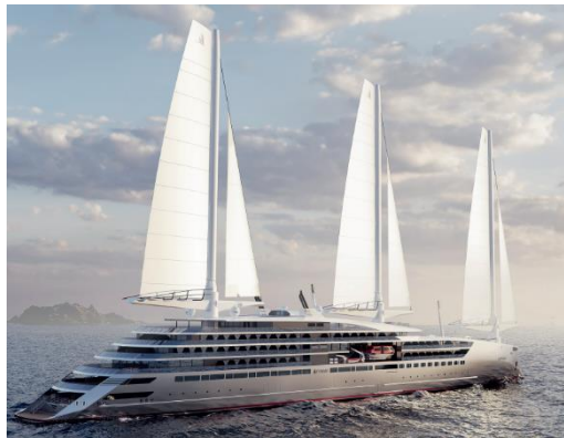
Dans le cadre de l'appel d'offre, 2 systèmes de propulsion vélique sont en cours d'étude. Ici une image 3D du projet Swap2Zero avec la technologie Solid Sail.
