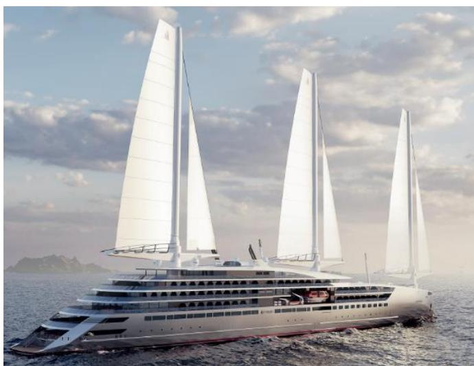
*Bildunterschrift: 3D-Animation des Swap2Zero-Projekts von PONANT. Im Rahmen der Ausschreibung werden zwei Segelantriebssysteme untersucht. Hier zu sehen mit der „Solid Sail“ Technologie.*
