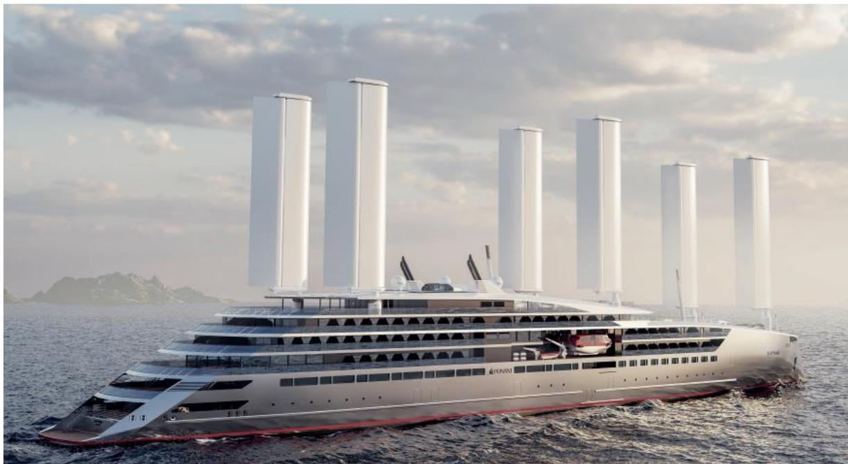
*Bildunterschrift: 3D-Animation des Swap2Zero-Projekts von PONANT. Im Rahmen der Ausschreibung werden zwei Segelantriebssysteme untersucht. Hier zu sehen mit der „Ayro’s Oceanwings®“ Technologie.
